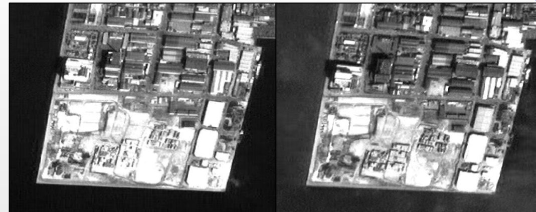
Рисунок 2 — снимки одного и того же места 2-мя разными объективами триплета PRIZM КА ALOS-2 с GSD (2.5 м) с одного участка орбиты имеют разные резкость и очень разный SNR [Apollo]
