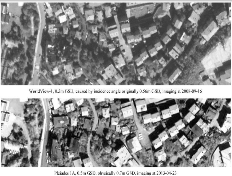
Рисунок 19 — Изображения одного и того же места, снятые различными КА, имеют разное качество в зависимости от параметров движения данных КА со съемочной ОЭА и самой этой ОЭА [17].
