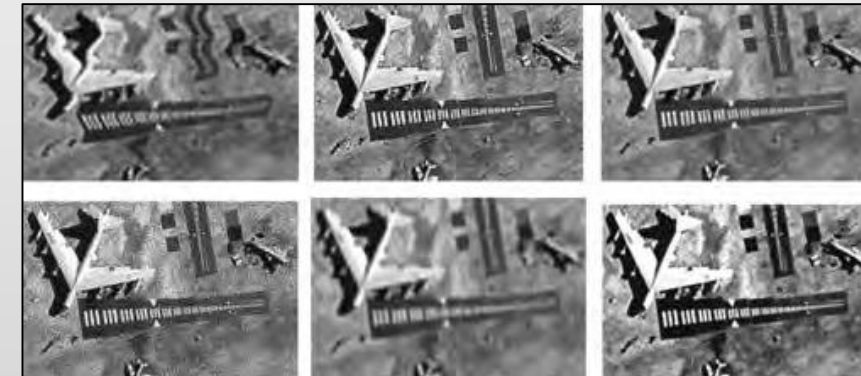
Рисунок 9 — Все 6 снимков одной и той же местности с одинаковым геометрическим разрешением ( GSD ) 0.5 м, но с разными другими качествами изображения [3].
