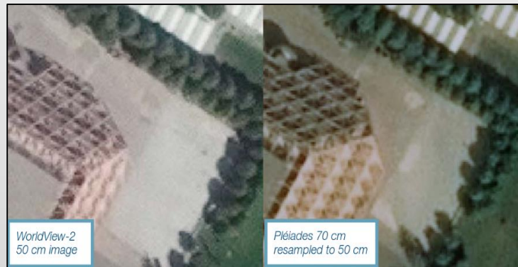
Рисунок 8 — Сравнение двух цветосинтезированных изображений с одинаковым GSD : с WorldView-2 с фокусом f_{WV} = 13.3\text{м} но и с Pleiades-1A с фокусом f_{Plei} = 12.5\text{м} и с разными радиометрическими качествами [8].
