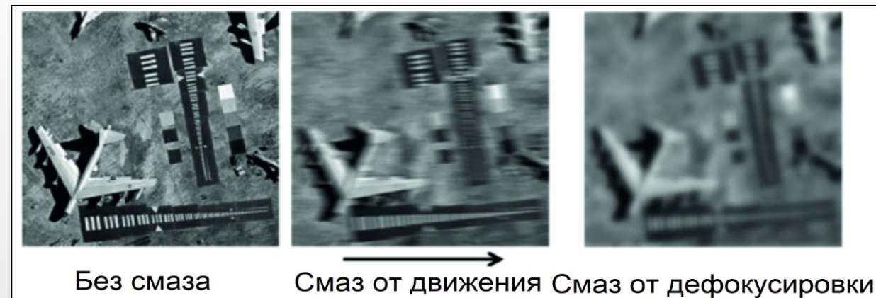
Рисунок 1 — Все 3 снимка одной и той же местности с одинаковым геометрическим разрешением (GSD) 0.5м, но с различными «смазами» и др. искажениями изображения [19]
