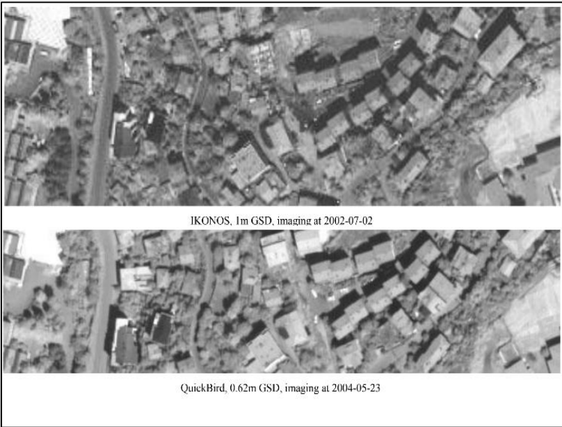
Рисунок 19 — Изображения одного и того же места, снятые различными КА, имеют разное качество в зависимости от параметров движения данных КА со съемочной ОЭА и самой этой ОЭА [17].
