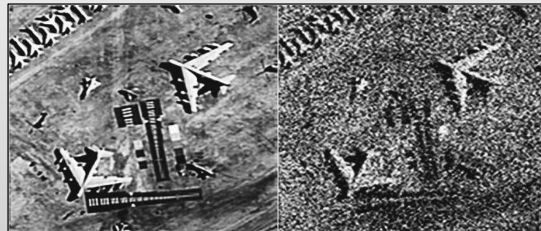
Рисунок 4 — Сильная зашумленность, в частности, из-за недостаточного времени накопления на ФПУ [3].
